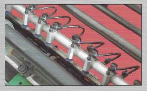
前吸式飞达,其前端边缘上的吸风系统,使得该飞达上料避免了敏感承印物的表面被刮花。适用于薄纸和胶片等带静电、易刮花承印物的印刷。即使是多色印刷,承印物的表面也不会有划痕;
