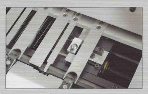
真空式侧规系统,配合侧规光纤定位,确保侧规定位的准确、可靠,同时完全避免了拉规定位的痕迹(拉规印);
