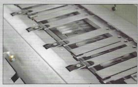
独特的滚筒凹槽设计,使得网距可调为接近于零, 实现了极小的网版变形,保证了印刷图案的准确度;
