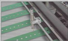
光电式防双张系统,检测装置与材料无接触,避免刮花;
