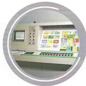
9. 燙金加熱系統控制中心 HEATER ZONE CONTROL CENTER
